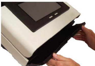
Stellen Sie vor dem Öffnen der Scan Station-Abdeckung sicher, dass die Abdeckung des Ausgabefachs heruntergeklappt ist.
