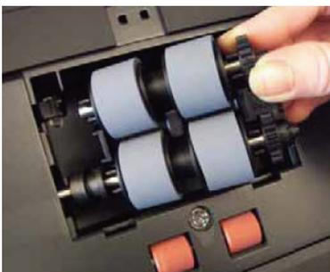
Setzen Sie das Einzugsmodul wieder ein, indem Sie die Stifte ausrichten und es nach links drücken. Achten Sie darauf, dass die Zahnräder korrekt ausgerichtet sind und das Modul einrastet. Kippen Sie das Einzugsmodul wieder in seine Position zurück.
