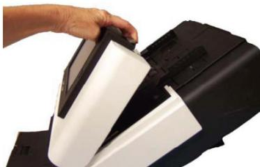
Drücken Sie den Entriegelungshebel der Scan Station-Abdeckung rechts und öffnen Sie die Scan Station-Abdeckung.
