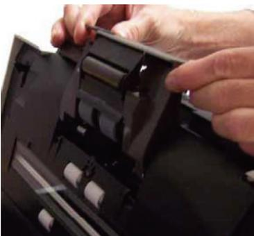
Setzen Sie das Separationsmodul wieder ein, indem Sie die Nasen an den Aussparungen ausrichten und das Modul einrasten lassen.
