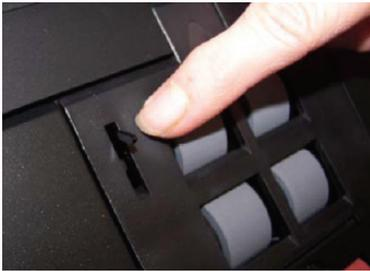
Achten Sie beim Herausnehmen oder Reinigen des Einzugsmoduls darauf, den Dokumentensensor nicht zu beschädigen.
