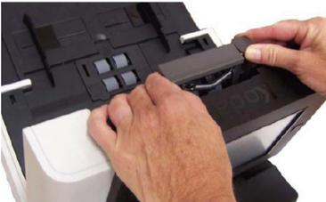
Drücken Sie das Separationsmodul nach oben, bis es freigegeben wird, und heben Sie es ab.
