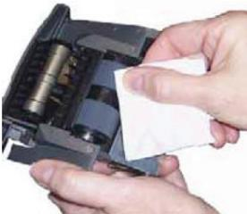
Drehen Sie die Rollen des Separationsmoduls und wischen Sie sie dabei mit einem mit Walzenreiniger WR1 benetzten Reinigungstuch RT2 ab.
