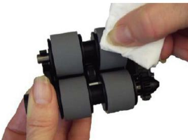
Drehen Sie die Rollengummis von Hand und reinigen Sie sie mit Hilfe eines mit Walzenreiniger WR1 benetzten Reinigungstuches RT2.
