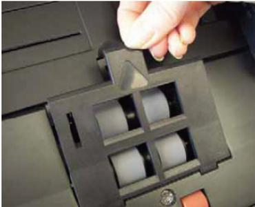
Ziehen Sie an der hervorstehenden Kante der Einzugsmodulabdeckung und nehmen Sie diese ab.
